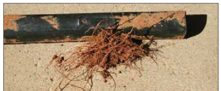
Figura 5. Raíces penetrando el gotero.
